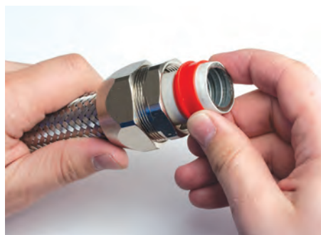
4. Наденьте зажимное уплотнительное кольцо красного цвета на металлорукав. Уплотнительное кольцо надевается стороной с утолщением под зажимную гайку
